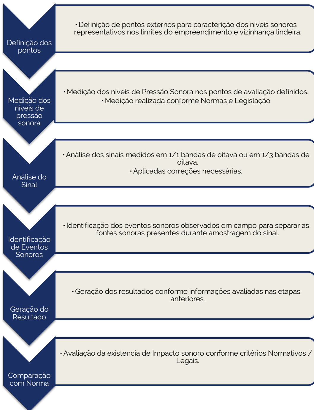
Figura 1 – Representação do processo de medição de ruído ambiental e análise.
